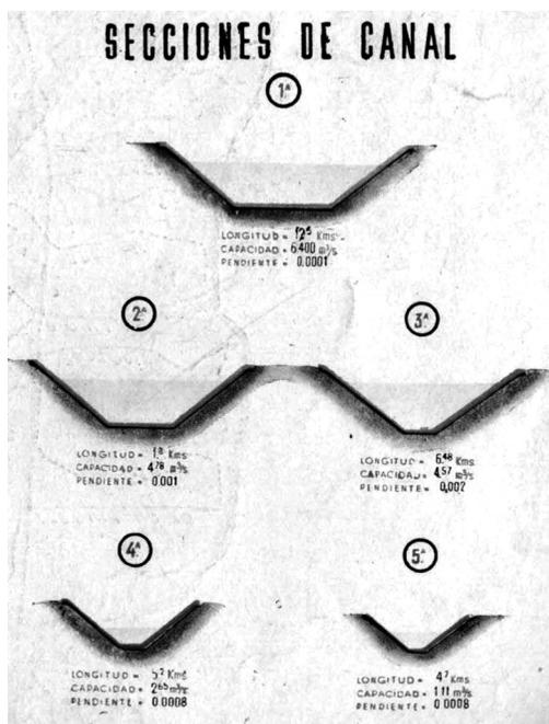
Perfil transversal de las cinco secciones del canal, con la especificación de anchura y pendiente.
