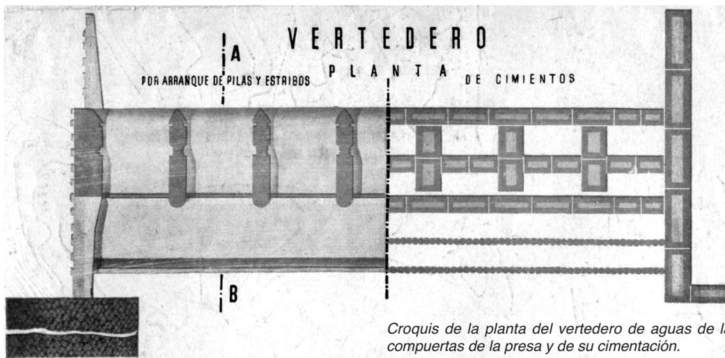
Croquis de la planta del vertedero de aguas de las compuertas de la presa y de su cimentación.
